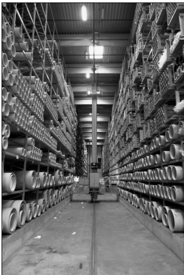
Figura 5 - Stoccaggio tubazioni con prelievo automatizzato Figure 5 - Pipe stock with automatic handling
