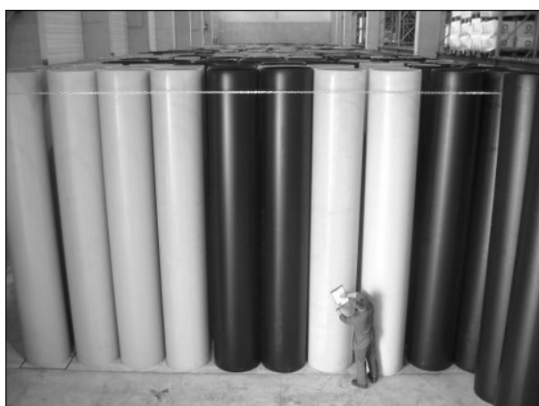
Figura 2 - Stoccaggio verticale di tubazioni di grande diametro Figure 2 - Vertical pipe stock for big diameter
