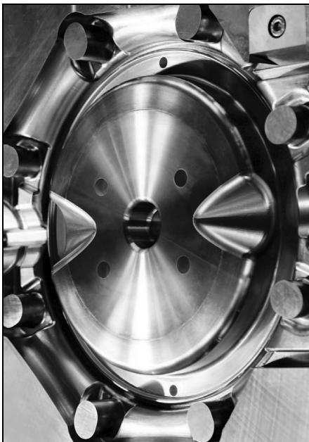
Figura 7 - Stampo per iniezione di una valvola a farfalla Figure 7 - Injection mould for a butterfly valve
