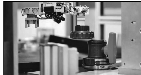
Figura 8 - Assemblaggio automatico di una valvola a sfera Figure 8 - Automated assembly of a ball valve
