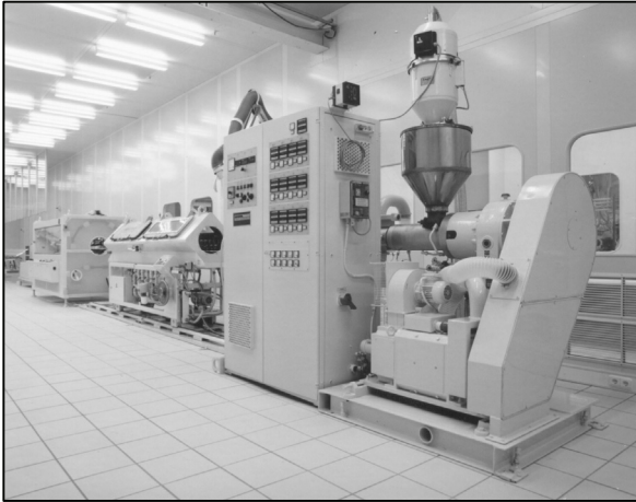
Figura 4 – Unità di estrusione in camera bianca Figure 4 – Pipe extruder unit in clean room
