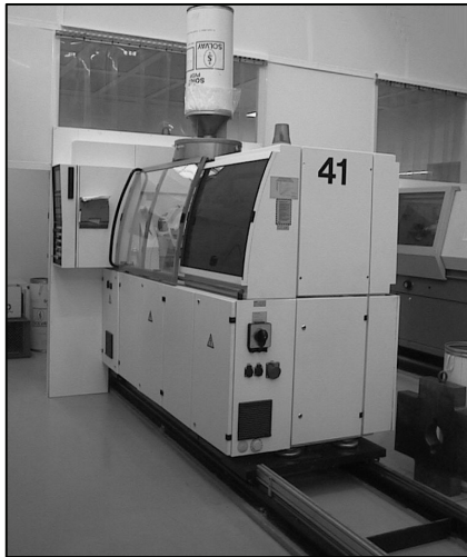
Figura 7 – Unità di stampaggio raccordi in camera bianca Figure 7 – Moulding machine for fitting in clean room
